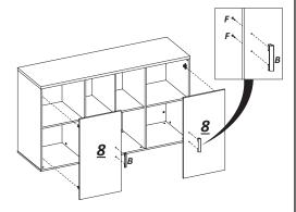
**2.6** Instale as portas e faça o ajuste das dobradiças. Fixe os puxadores com os parafusos indicados.
